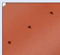
Die Löcher des Tonfilters sind exakt verarbeitet und haben einen Durchmesser von  $\leq 2\text{mm}$ .
